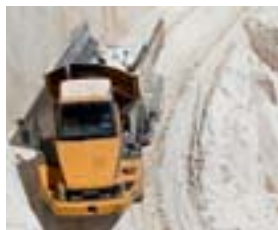
Mniejsze bloki marmuru wywozi z kopalni wozidło przegubowe Cat 725.
