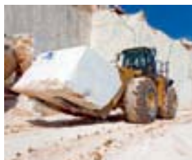
Duży blok marmuru jest transportowany z kamieniołomu do pobliskiego zakładu kamieniarskiego.
