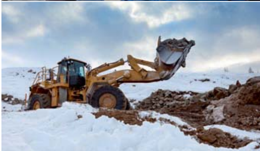
Ładowarki kołowe 988 H (powyżej) i równiarki samobieźne 16H pełnią ważną funkcję w budowie i utrzymaniu 150 km dróg transportowych.
