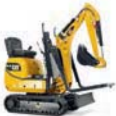
Najmniejsza maszyna Cat: wysokość 1507 mm, szerokość 730 mm.
