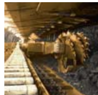
Wrębiarka Cat EL4000 z łatwością odcina bryły węgla z podziemnego pokładu.
