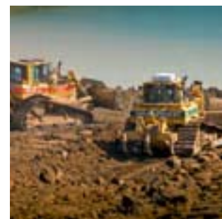
Spycharki gąsienicowe D6, jedno z 40 maszyn Cat wykorzystywanych w projekcie.
