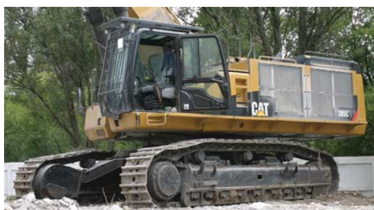
Dzięki maszynie CAT 385C UHD firma Tree Polska mogła pozyskać wiele ciekawych kontraktów na terenie całej Polski. Jej kabina jest zabezpieczona solidnymi kratami, które chronią operatora przed spadającymi odłamkami wyburzanego obiektu.
